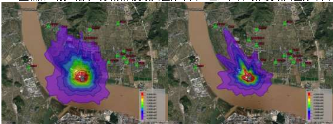
图 6.2-25 叠加后 DMF 小时贡献浓度最大值分布图（左）和日均浓度最大值分布图（右）
