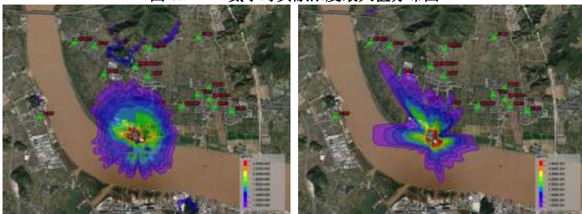
图 6.2-18 氯化氢小时贡献浓度最大值分布图（左）和日均浓度最大值分布图（右）
